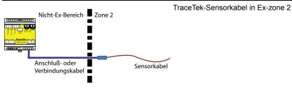
In Verbindung mit einer Ex-geeigneten, zugelassenen Zener-Barriere können TraceTek Sensorkabel in Ex-Zonen 0 oder 1 verlegt werden
